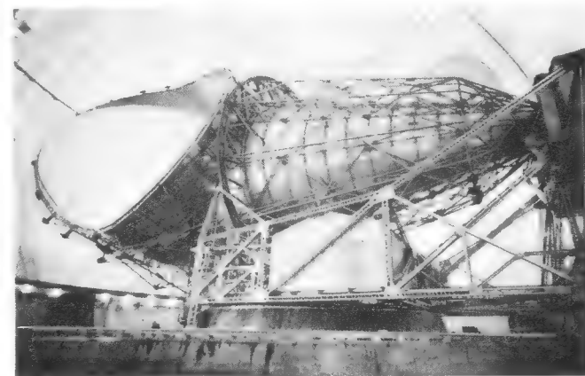
Bild 6. Die vierteilige Wendelantenne für die Grobortung des Satelliten mit Hilfe seiner dauernd ausgestrahlten Meldefrequenz von 136 MHz. Dahinter der 20 m hohe Turm zum Eichen dieses Grobradars und eines weiteren Präzisionsradars, das auf \frac{1}{100} Winkelgrad genau den Satelliten ortet
