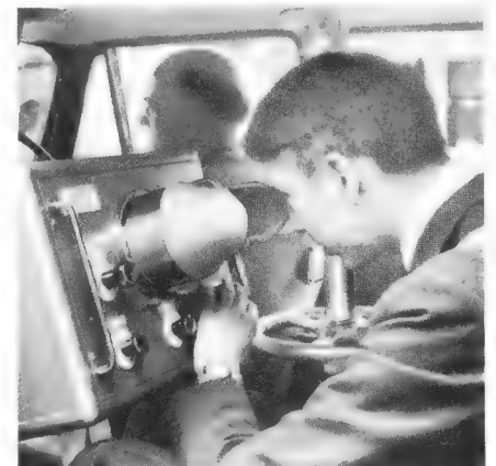
Unten: Bild 2. Der Beobachter am Panoramaempfänger; das Antennenhandrad ist deutlich sichtbar. Der Einblick ist gepolstert, um Verletzungen beim Arbeiten im Fahren zu vermeiden
